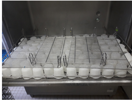
Une grille placée pour maintenir les moules individuels pour un lavage en lave-batterie.
